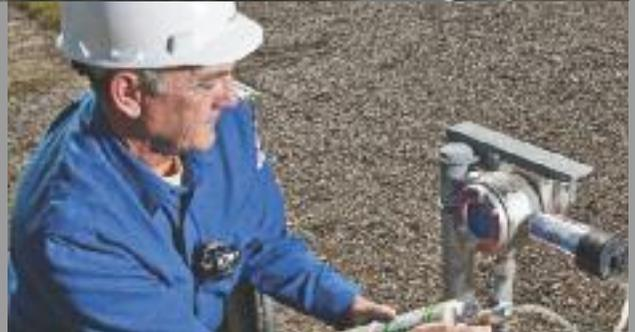
La operación del monitor Ultima XIR está basada en una longitud de onda dual, con tecnología de calentamiento óptico que proporciona una compensación definitiva contra la temperatura, la humedad y los efectos del desgaste. La tecnología IR ofrece excelente estabilidad a largo plazo, elimina la necesidad de calibraciones frecuentes y reduce el costo total de propiedad.
