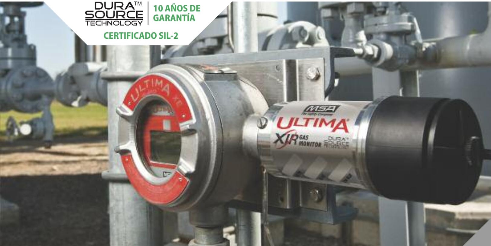
*El monitor de gas Ultima XIR es un detector puntual tipo infrarrojo a base de microprocesador para un monitoreo continuo de gases y vapores combustibles y de dióxido de carbono. Su diseño cuenta con una carcasa resistente, de acero inoxidable 316 y tiene varias entradas para una máxima flexibilidad.*
